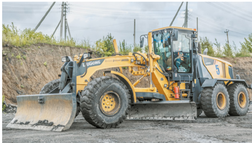
Китайский автогрейдер необходим для ямочного ремонта и других дорожных работ.
