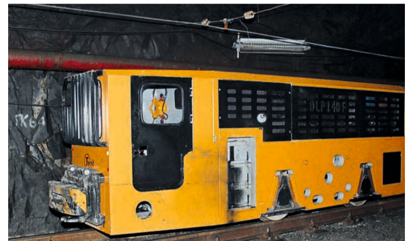
Дизелевоз – подземный локомотив для рельсовой транспортировки людей и грузов в шахтах.
