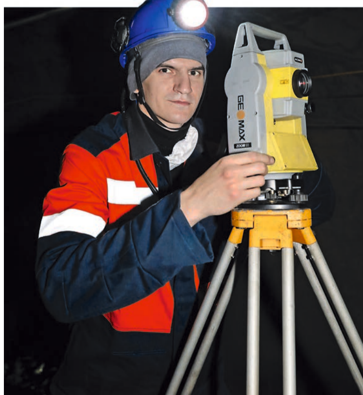
Александр Лапин, участковый маркшейдер: – Работа с электронным тахеометром проста, как использование смартфона. Нажал кнопку, прибор взял отчет и выдал готовые цифры. Погрешность всего 5 секунд.
