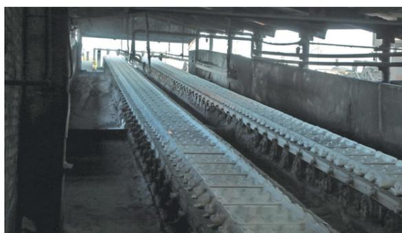
↑ Прежде всего будут полностью заменены ролики и цепи конвейеров с мульдами.
