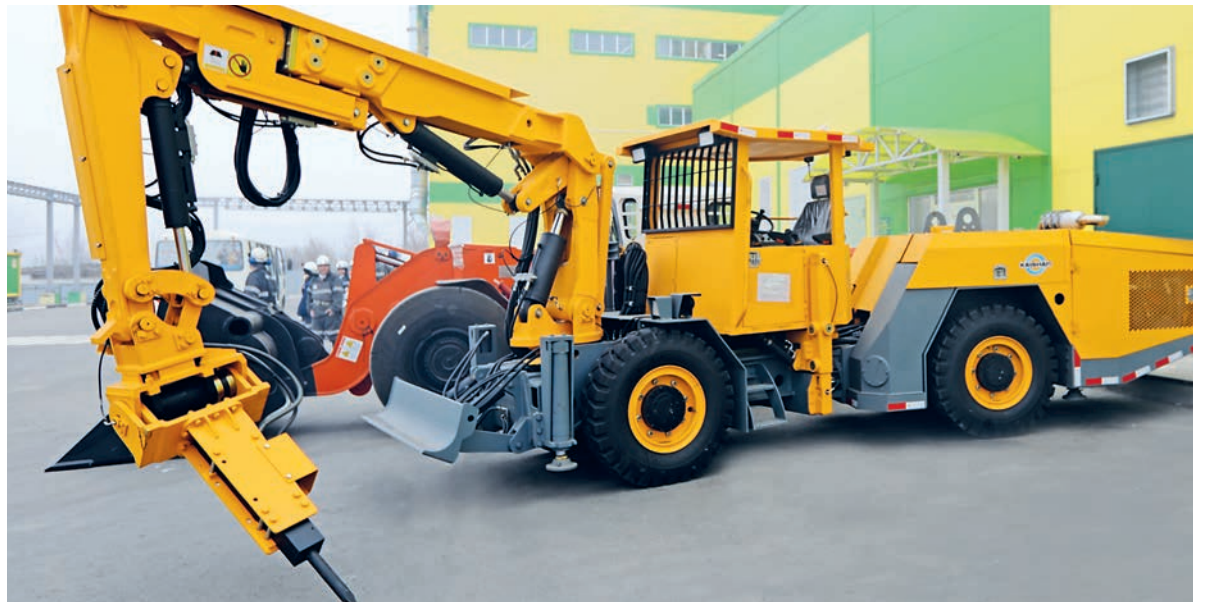
Габаритную кровлеоборочную машину опустят в шахту по частям: основной корпус отдельно от стрелы с пневмоперфоратором.
