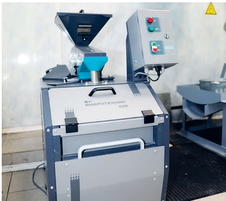
Оборудование состоит из лабораторной мельницы, делителя, аналитической машины с двенадцатью ситами и ячейками разного размера и т.д.
