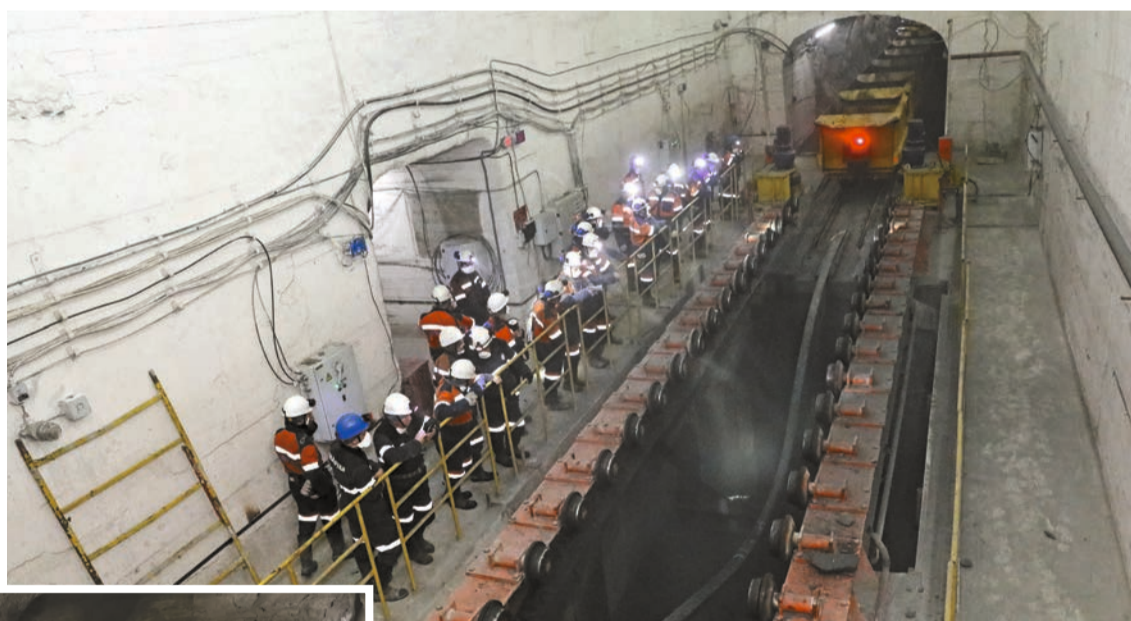
В камеру донной разгрузки въезжает состав с рудой из камеры 2/1/15
