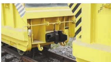
Автосцепка – приспособление для автоматической сцепки вагонов
