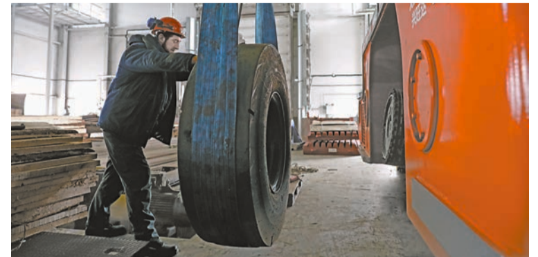
На участке капитального ремонта горно-шахтного оборудования ПДМ разобрали перед спуском.
