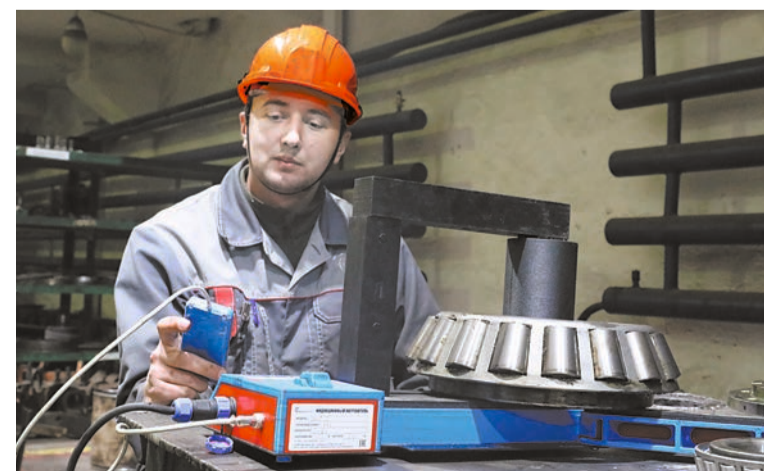
Индукция нагревает подшипник в пять раз быстрее.
